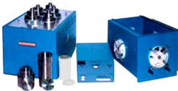
Рисунок 2.1 – Аналітичні модулі автоклавної пробопідготовки з резистивним нагріванням МКП-04 і МКП-05
