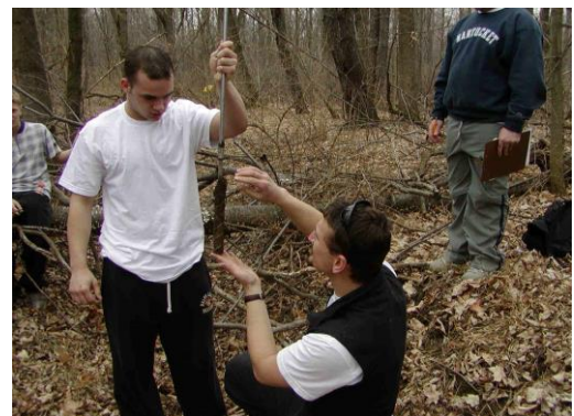
Рисунок 1.9 – Пробовідбірники ґрунтів та відбір проб ґрунту
