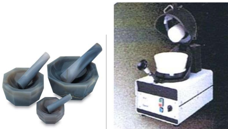
Рисунок 1.4 – Ступки для тонкого перетирання проби
