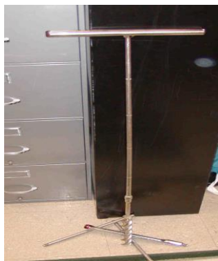
Рисунок 1.9 – Пробовідбірники ґрунтів та відбір проб ґрунту
